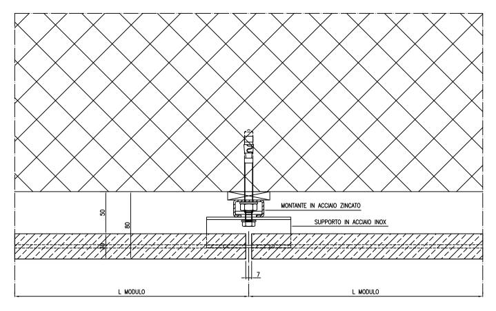
MONTANTI IN ACCIAIO ZINCATO E SUPPORTI IN ACCIAIO INOX. FISSAGGI SULLE COSTE
